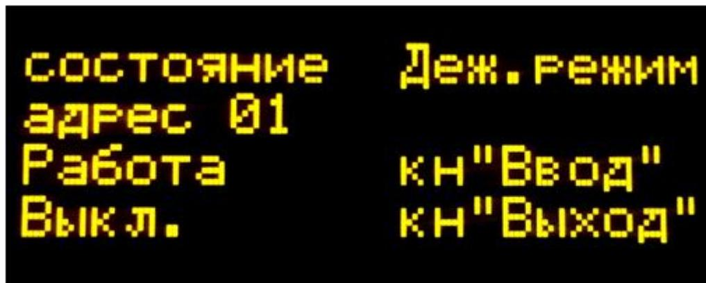
Примечание – «адрес ХХ» - адрес извещателя при работе по интерфейсу стандарта EIA RS-485, значение «ХХ» - может устанавливаться от «01» до «99».
