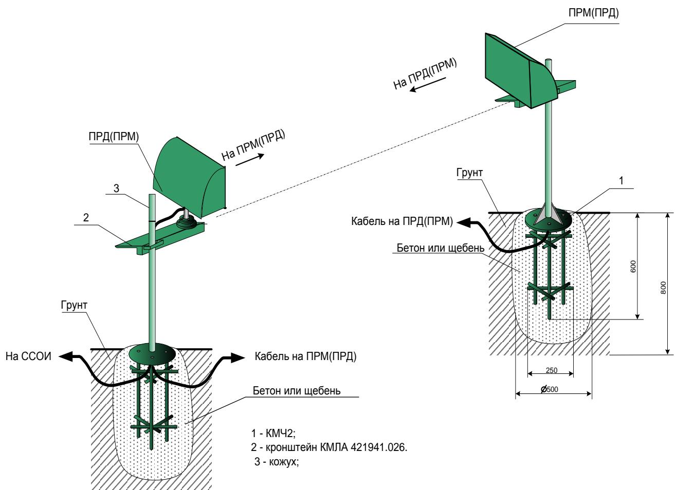
Рисунок 2.3.1 - Вариант установки ПРД, ПРМ «РИФ-РЛМ-24»
