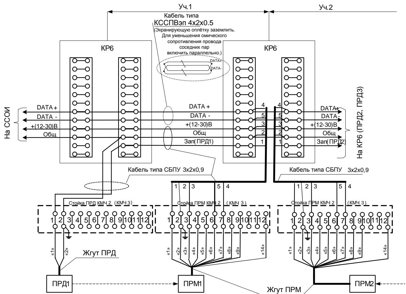
Рисунок 2.3.5 – Электрическая схема подключения изделий с интерфейсным выходом при организации протяжённого рубежа охраны.
