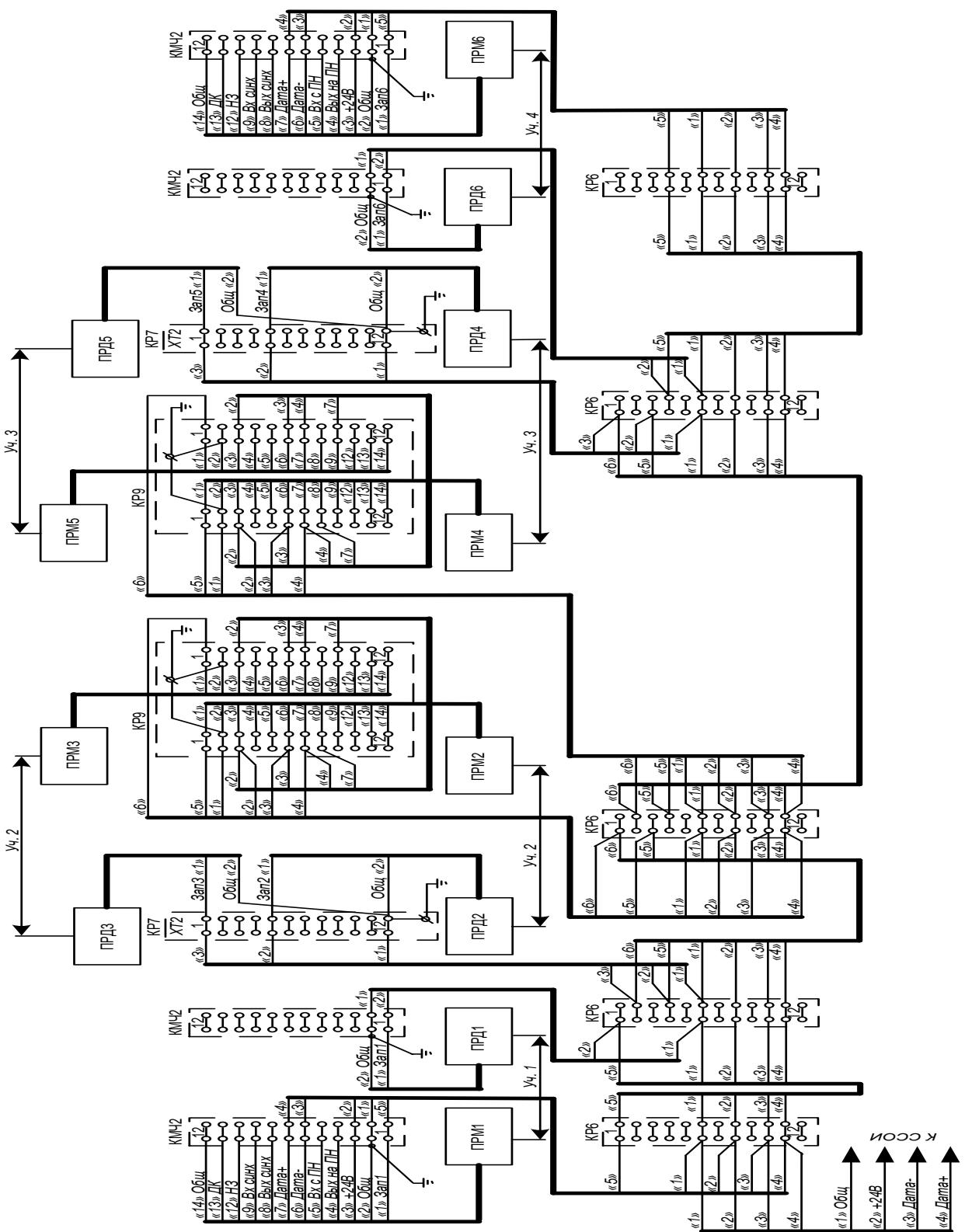
Рисунок 2.3.7 - Электрическая схема подключения изделий с интерфейсными выходами при установке в два яруса на протяженном рубеже охраны
