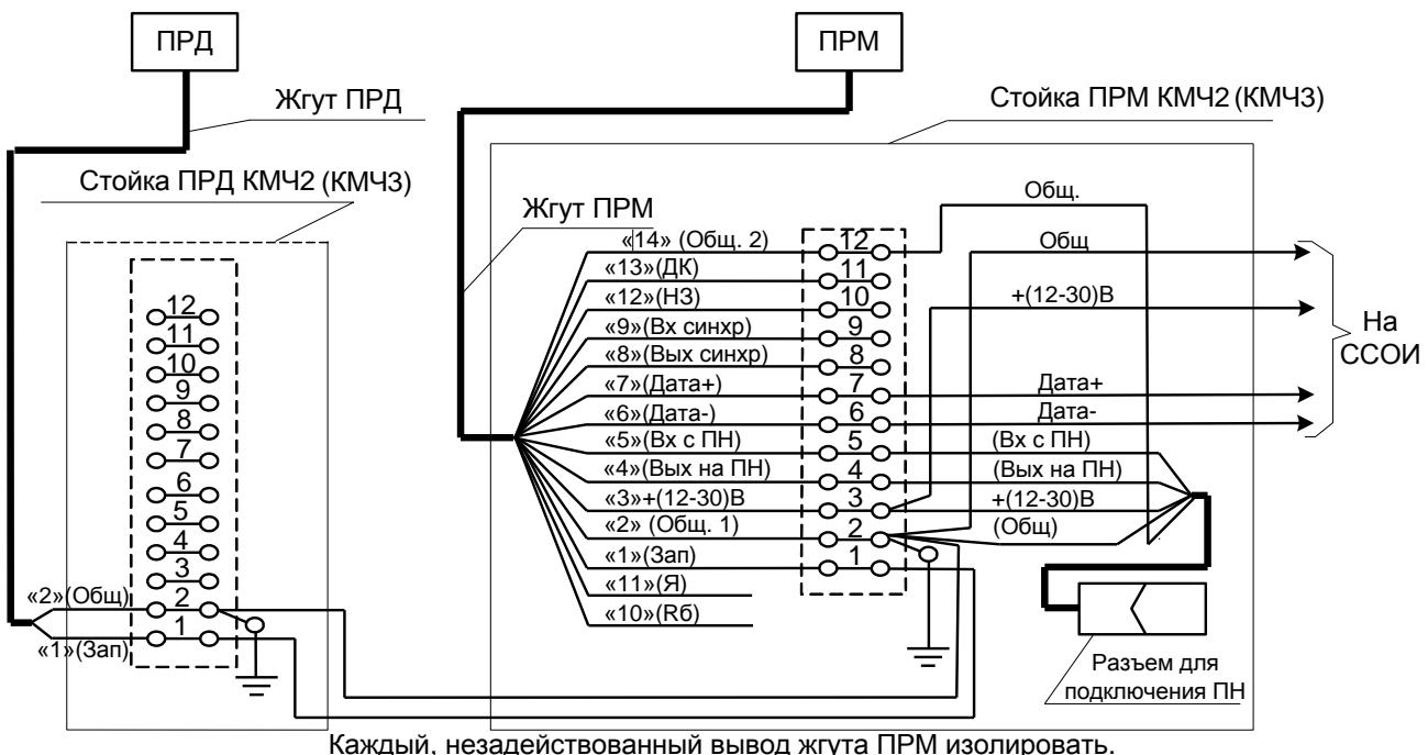
Рисунок 2.3.2 – Схема подключения изделия с интерфейсным выходом.
