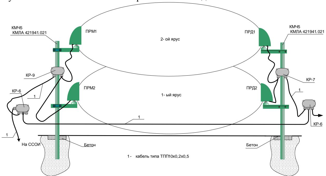
Рисунок 2.2.3 Вариант установки ПРД, ПРМ «РИФ-РЛМ-24» на охраняемом участке в два яруса.
