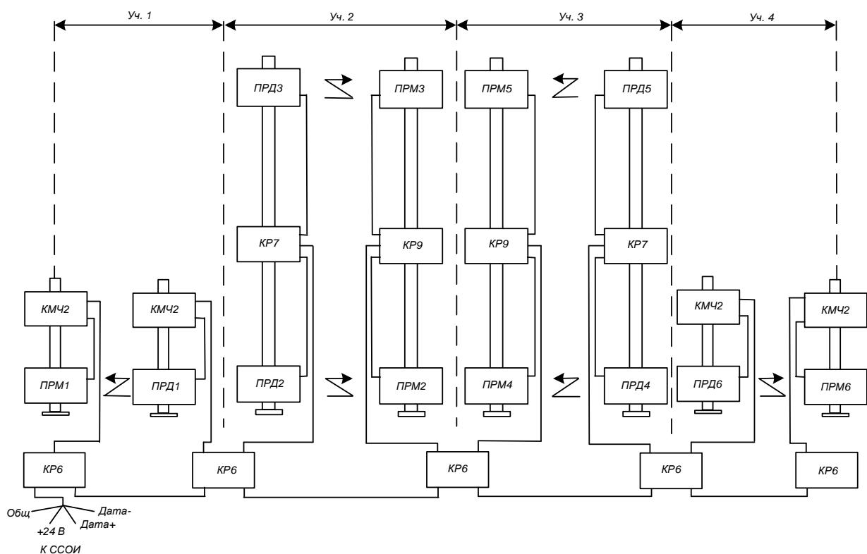
Рисунок 2.3.6 - Функциональная схема подключения изделий с интерфейсными выходами при установке на 4x участках периметра, при этом на участках №2 и 3 изделия установлены в 2 яруса.
