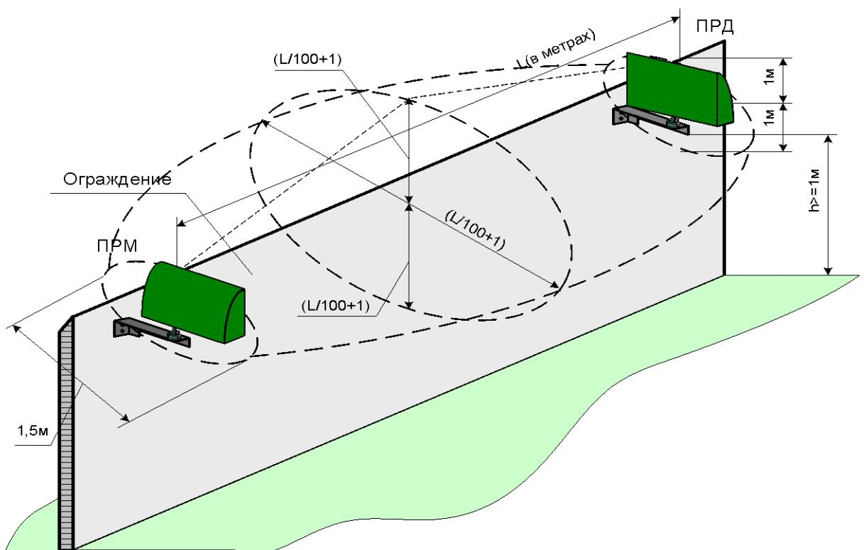
Рисунок 2.2.2 Границы зоны отчуждения (пунктир) при установке ПРД, ПРМ «РИФ-РЛМ-24» по верху ограждения.
