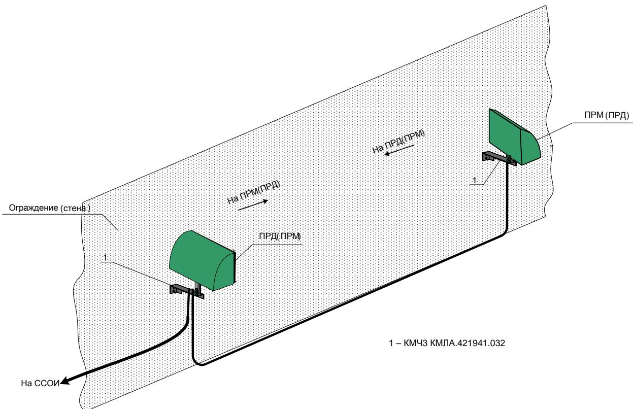
Рисунок 2.3.2 - Вариант установки ПРД, ПРМ «РИФ-РЛМ-24» на ограждении (стене).
