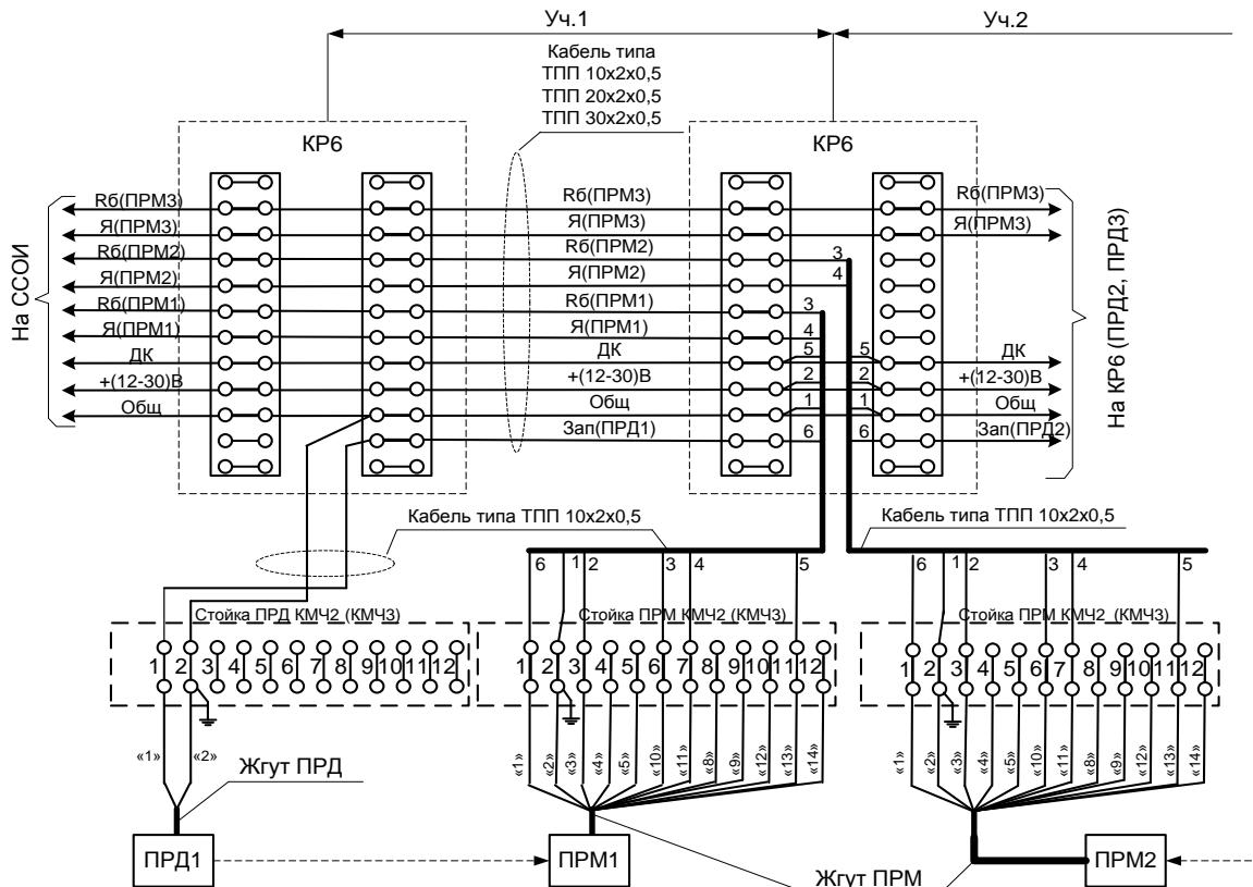
Рисунок 2.3.4 – Электрическая схема подключения изделий с релейным выходом при организации протяжённого рубежа охраны.
