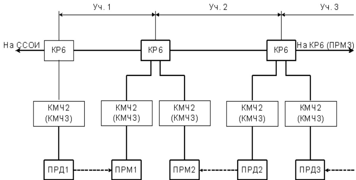
Рисунок 2.3.3 – Функциональная схема подключения изделий с интерфейсным выходом при организации протяжённого рубежа охраны.
