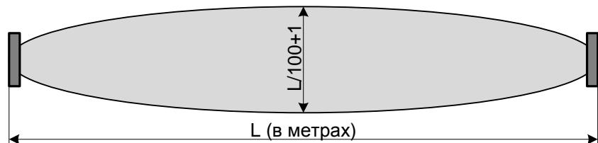
Рис. 2.2.1. Границы зоны отчуждения при установке ПРД, ПРМ изделия «РИФ-РЛМ-24» на открытом участке местности.
